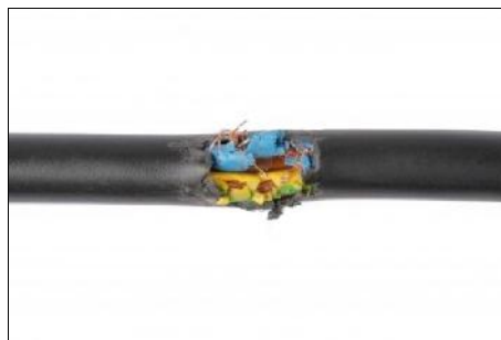
Beschadigde elektrische kabel
