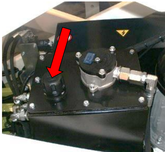
Zicht op de vuldop van de hydrauliekolietank
