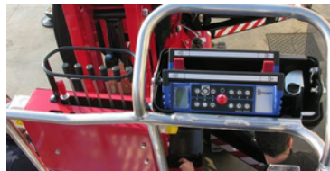
Afstandsbediening correct geïnstalleerd in de houder van de werkbak
