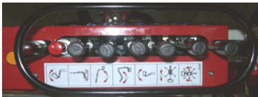
Hydraulisch gedeelte van de verdeler in de werkbak
