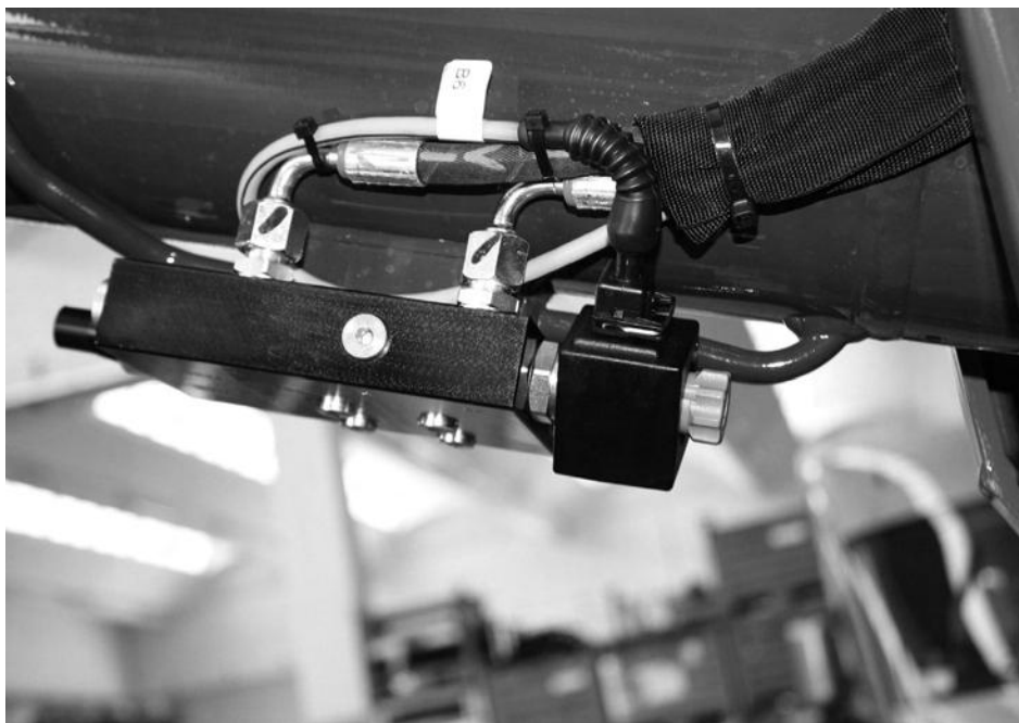
Fig. 66 Elektrokleppen voor de nooddaling wegens ernstige situatie
