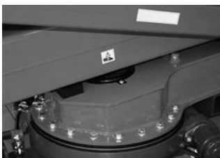
Fig. 97 Afknelpgevaar op machine 2
