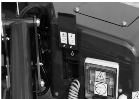
Fig. 131 Aansluitdoos in ruimte met elektrische componenten.
