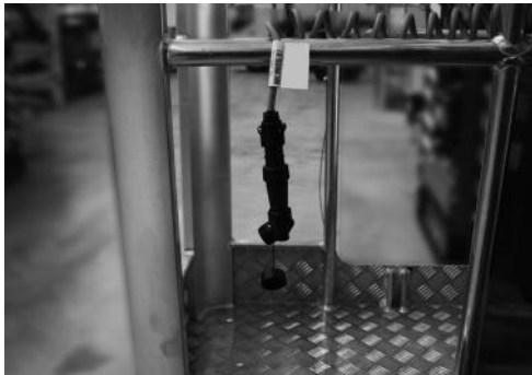
Fig. 170 Serviceaansluiting op hoogwerkerbak
