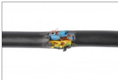
Beschadigde elektrische kabel
